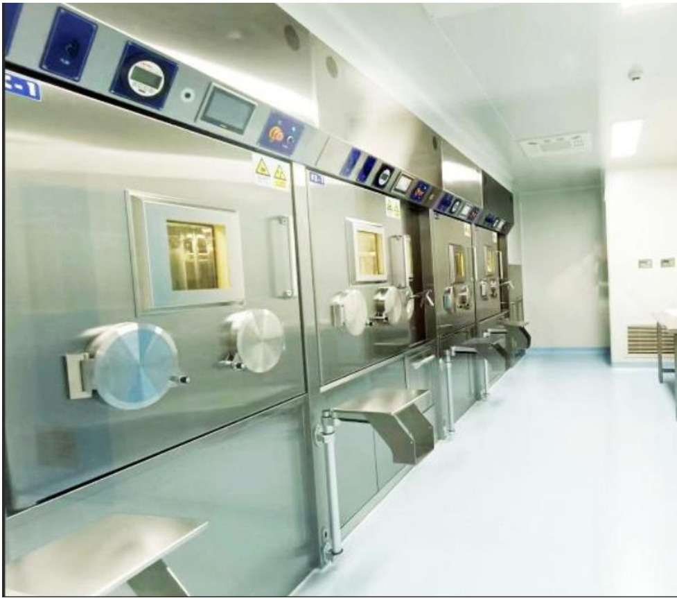
图 4-2 典型放药生产热室示意图
